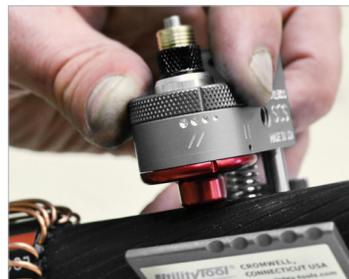
El ancho del espiral puede ajustarse para cuatro posiciones y diferentes diámetros de cables.
