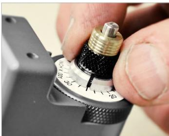
La profundidad de la cuchilla es fácilmente ajustable y se gradúa girando el dial.
