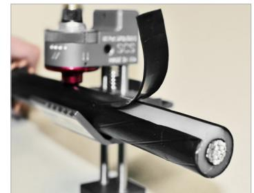
Para realizar cortes longitudinales, solo tire la herramienta a lo largo del cable.
