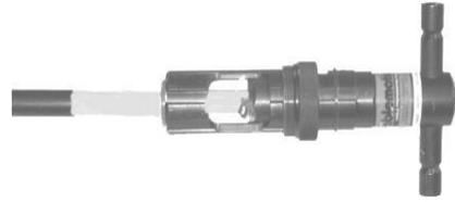
**Paso 3.** Retire el compuesto de inundación del cable. Núcleo y tira el cable utilizando el QCST para completar la preparación.
