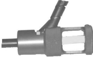
**Paso 2.** Coloque la herramienta en el extremo del cable y remueva la cubierta hasta que el extremo del cable desmontado esté nivelado con el extremo de la herramienta. Esto dará como resultado un corte de la chaqueta de 3 1/2" (89.9 mm) (corte de la chaqueta de 2 1/2" después de la operación de la coradura).
